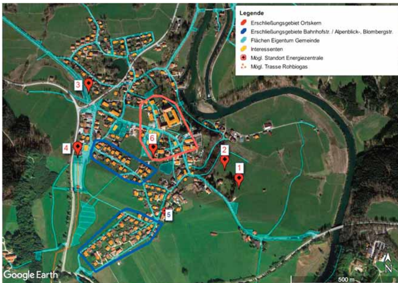
Schema Erschließungsgebiete/mögliche Standorte Energiezentrale
